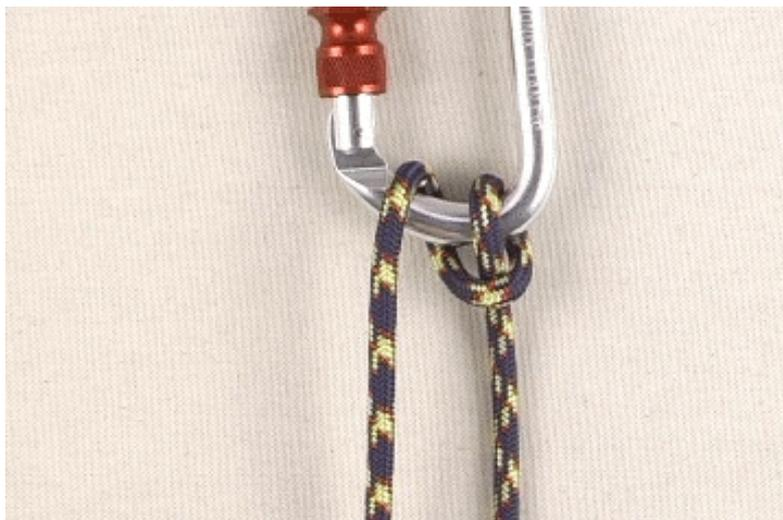
Les frottements constitués par ce nœud permettent le coulissement maîtrisé d'une corde en tension, mais ne la bloquent pas.
